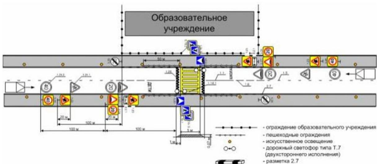
Рисунок 18 - Типовая схема расположения ТСОДД при двухполосном движении транспортных средств.
